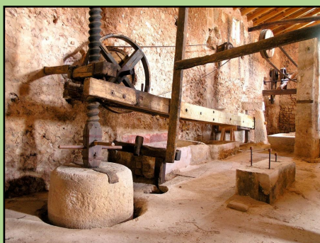
Premsa de biga. Son Torrella (Santa Maria del Camí). Premsa mecànica. S'Alqueria Vella de Baix (Artà)
